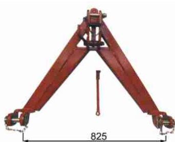
Anbaudreieck Kat. II zum einfachen Ankuppeln von Front- und Heckgeräten Triangle de montage cat. II pour l'accouplement simple d'équipements frontaux et arrière
